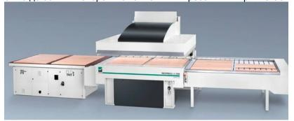
площадью, но и производительностью. За счет данная расположенного снизу генератора. установка идеально подходит как для мелких, так и средних цехов. Время на прессование, при использовании материала толщиной даже 90 мм, составляет 3 минуты, что является рекордным показателем. Новый тип конструкции эффективно влияет на подачу высокочастотной энергии в клеевой шов. Далее происходит сокращение вспомогательного времени минимума одновременно для загрузки и разгрузки зоны
