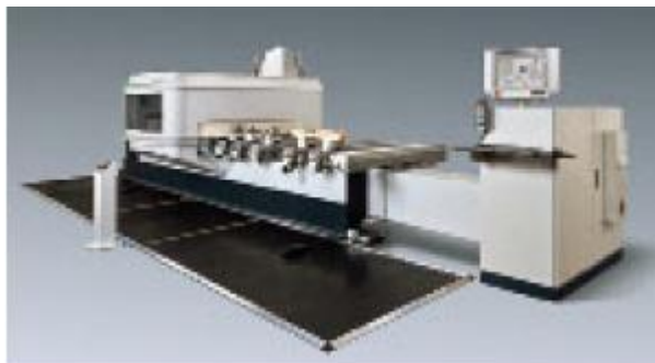
Обрабатывающий центр Weinig Multirex линией оконного производства.
