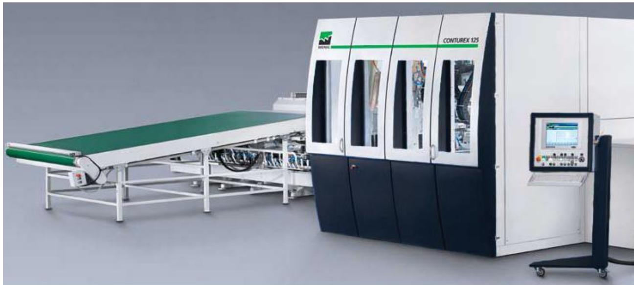
Профилирующий центр **Conturex** - новая производственная технология от **WEINIG**, благодаря которой обеспечивается полная комплексная обработка заготовок со всех шести сторон путём чётко согласованных действий различных агрегатов на этом оборудовании. Возможно рентабельное производство даже при изготовлении единичных деталей. Пиление, фрезерование, сверление, шлифование всех профилей – данный центр с технологией **ЧПУ** обеспечивает полный и непрерывный цикл обработки!
