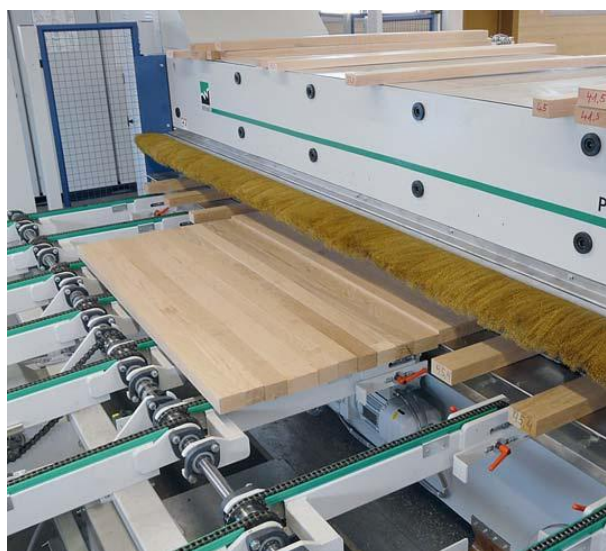
Одна плита четыре минуты находится в высокочастотном прессе Dimter, пока ее вытолкнет другая плита.
