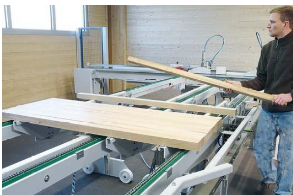
Второй оператор линии проверяет качество древесины и укладывает ламели в соответствии с заказанным рисунком.
