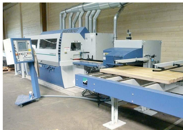
Станция подачи ламелей (справа) и автоматический четырехсторонний строгальный станок Powermat 500 компании Weinig.
