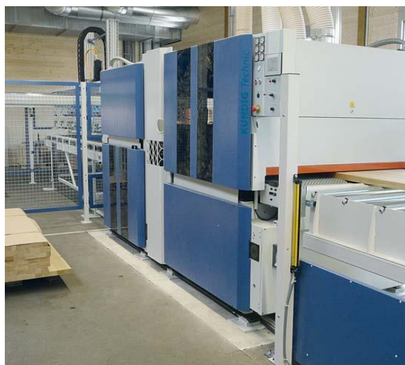
Станок для склеивания ламелей Dimter: деревянные заготовки разделяются, склеиваются и собираются в плиту.
