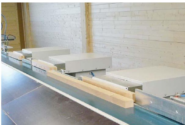
За строгальным станком – участок с механизмом выброса коротких сращенных ламелей и тремя толкателями для выброса длинных ламелей до 5м.
