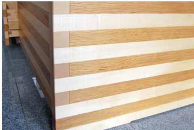
Точная работа: готовые к склеиванию бруски для кровати после обработки на станке Cube
